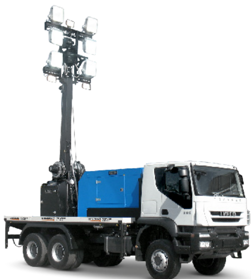
20 m verlichting toren met 100 kVA generator op de IVECO Maxi Vrachtwagen
